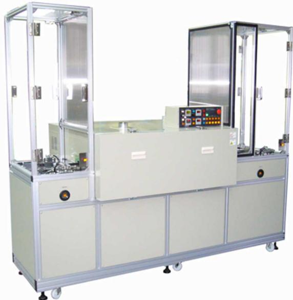
※熱処理後は、パレットを強制冷却し供給側に戻る回流方式です
