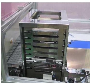
●パレットを一時保管し強制冷却
